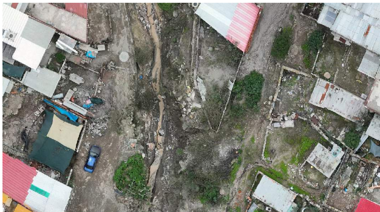
IMAGEN 02: EN ESTE TRAMO SE OBSERVA LA VISTA DE DRON, VIVIENDAS, CERCANAS AL CAUCE DE LA QUEBRADA PASTORAIZ, DONDE SU CAJA HIDRÁULICA SE ENCUENTRA COLMATADO DE SEDIMENTOS.
