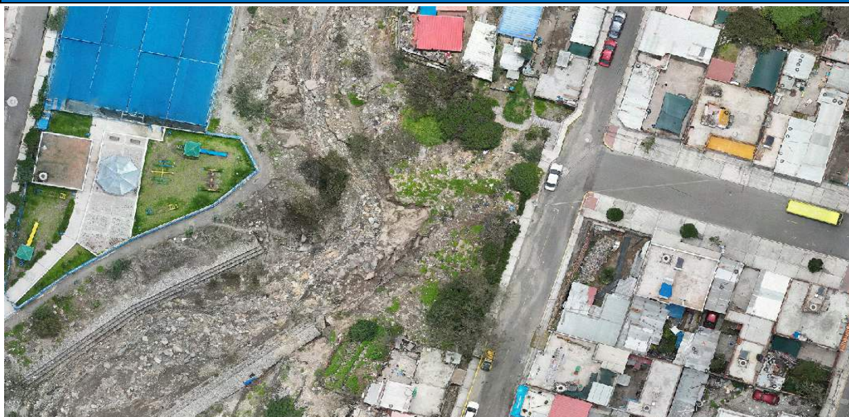
IMAGEN 01: SE OBSERVA LA VISTA DE DRON, VIVIENDAS, Y VIAS, CERCANAS AL CAUCE DE LA QUEBRADA PASTORAIZ, DONDE SU CAJA HIDRÁULICA SE ENCUENTRA COLMATADO DE SEDIMENTOS, Y PROTECCIÓN DE GAVIONES EN AMÁRGENES EN UN TRAMO.
