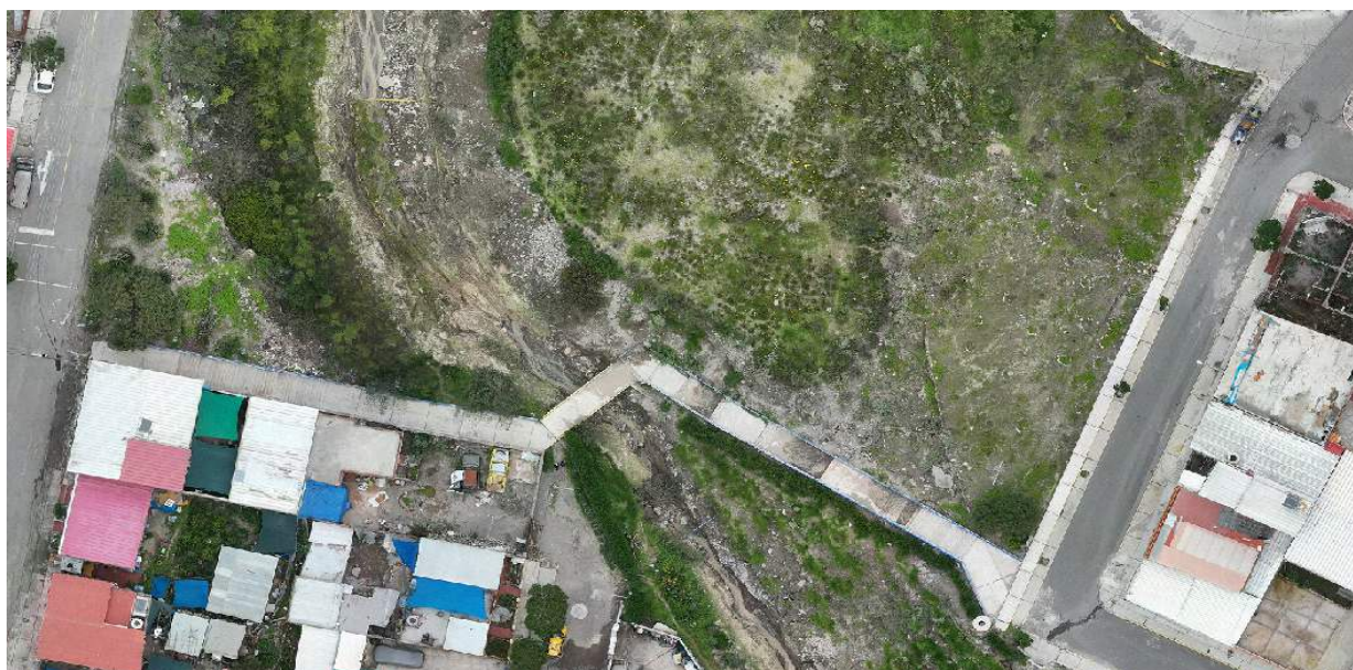
IMAGEN 03: EN ESTE TRAMO SE OBSERVA LA VISTA DE DRON, DONDE EL CAUCE DE LA QUEBRADA PASTORAIZ, SE ENCUENTRA COLMATADO, Y UN PUEBLO PEATONAL.
