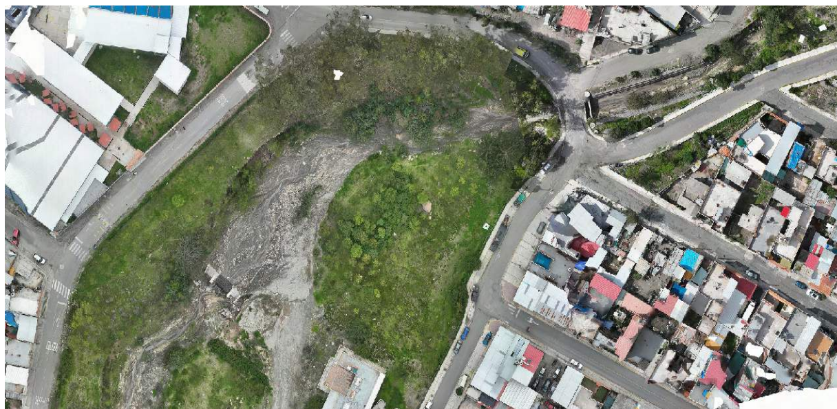
IMAGEN 04: EN ESTE TRAMO SE OBSERVA LA VISTA DE DRON: DONDE EL CAUCE DE LA QUEBRADA PASTORAIZ, SE ENCUENTRA COLMATADO, OY SIN PROTECCIÓN AMBAS MÁRGENES DE DICHA QUEBRADA.
